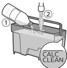
**7** Наполните резервуар чистой водой до отметки CALC CLEAN. Установите резервуар для воды обратно в машину, затем нажмите OK.
