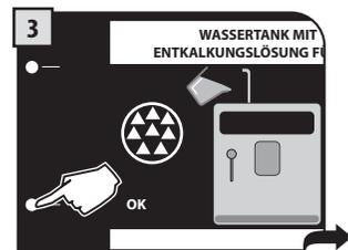
Den Tank mit Entkalkungslösung füllen. Bestätigen, indem die Taste "OK" gedrückt wird.
