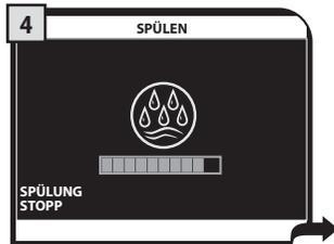
Nach Abschluss der Aufheizphase führt die Maschine einen Spülzyklus der internen Systeme durch. Der Zyklus kann abgebrochen werden, indem die Taste "SPÜLUNG STOPP" gedrückt wird.
