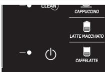
Rote LED blinkt. Maschine in Standby.
