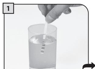
1 Immergere, per 1 secondo nell'acqua, il provino per i test di durezza dell'acqua, presente nella macchina.
