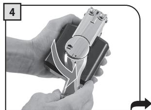
4 Ruotare il manico nella posizione di sblocco ruotandolo in senso antiorario.
