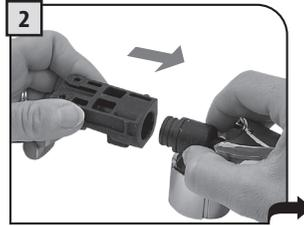
Den äußeren Anschlussstutzen auf den inneren Stutzen aufsetzen. Die Einsteckrichtung wird vom Pfeil angezeigt.
