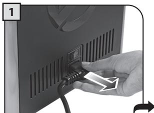
1 Die Maschine ausschalten und den Netzstecker ziehen.
