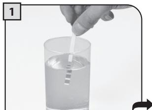
Den Teststreifen für die Wasserhärte für einen Zeitraum von 1 Sekunde in das in der Maschine befindliche Wasser eintauchen.
