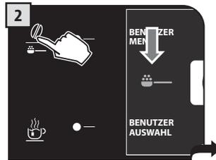
2 Die Taste einmal oder mehrmals drücken, bis das Symbol auf dem Display angezeigt wird.
