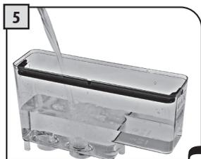
5 Riempire il serbatoio con acqua fresca potabile; non superare mai il livello massimo riportato sul serbatoio. Riposizionare infine il serbatoio.
