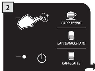
Die Taste drücken. Die Maschine führt einen zusätzlichen Reinigungszyklus aus.
