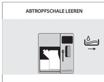
Die vordere Tür öffnen und die Abtropfschale, die sich unter der Brühgruppe befindet, leeren.
