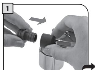
Inserire il raccordo interno nel tubo e premerlo fino in fondo.
