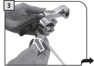
Den Schlauch in den äußeren Anschlussstutzen einstecken.
