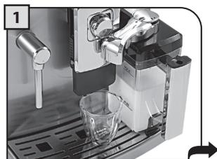
1 Posizionare la tazzina di dimensioni adeguate. Ruotare la parte superiore del manico del contenitore sulla tazza.
