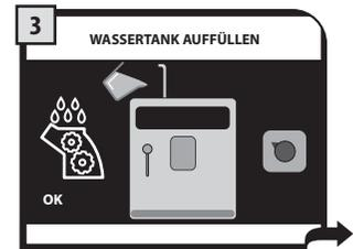
Den Wassertank mit frischem Trinkwasser füllen. Nachfolgend "OK" drücken.
