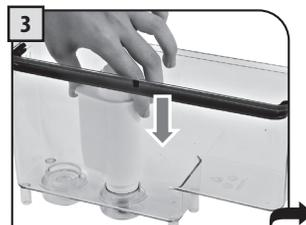
3 Inserire il filtro nella sede all'interno del serbatoio vuoto (vedere figura). Premere fino al punto di arresto.
