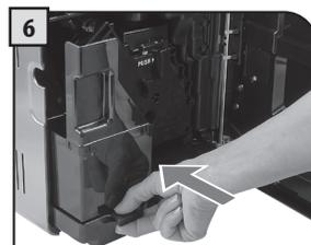
6 Die Schale und den Kaffeersatzbehälter einsetzen und die Servicetür schließen.
