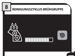
Der Reinigungszyklus der Brühgruppe wird automatisch ausgeführt.
