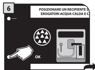
Posizionare un contenitore sotto all'erogatore e un contenitore sotto al tubo acqua calda. Dopo premere "OK".
