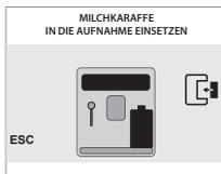
Es wurde ein Vorgang angewählt, der die Ausgabe aus dem Milchbehälter erfordert. Den Behälter in die Maschine einsetzen, wie im Handbuch erläutert.
