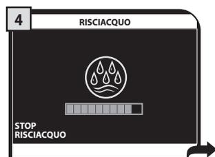
4 Terminato il riscaldamento, la macchina esegue un ciclo di risciacquo dei circuiti interni. Si può interrompere il ciclo premendo il tasto "STOP RISCIACQUO".
