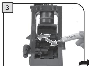
3 Solo con il grasso fornito in dotazione, lubrificare le guide del gruppo.
