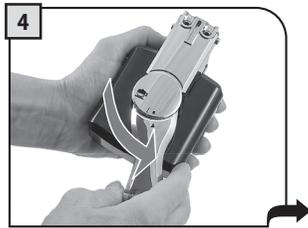
4 Den Griff in die Freigabeposition drehen, indem er im Gegenuhrzeigersinn gedreht wird.
