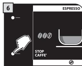
La macchina termina l'erogazione del caffè automaticamente secondo le quantità impostate in fabbrica. È possibile personalizzare le quantità vedere pag.24.
