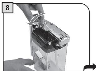
Ruotare il manico in senso antiorario per riportarlo nella posizione di chiusura.
