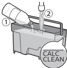
**10** Наполните резервуар чистой водой до отметки CALC CLEAN. Установите резервуар для воды обратно в машину, затем нажмите OK.
