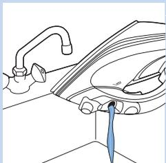
**2** Izpraznite zbiralnik za vodo in likalnik pustite na varnem, da se ohladi.
