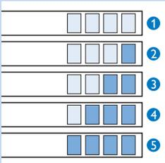
**3** Preverite, koliko kvadratkov na testnem traku je spremenilo barvo, in to primerjajte s podatki v spodnji tabeli trdote vode.
