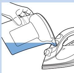
*Poznámka: Ak používate filter na odstraňovanie vodného kameňa IronCare, môžete zásobník na vodu naplniť filtrovanou vodou priamo z tohto filtra.*
