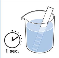
**1** Testni trak za 1 sekundo pomočite v vodo iz pipe.
