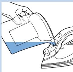
*Napomena: Ako koristite IronCare filter za uklanjanje kamenca, možete da napunite rezervoar za vodu filtriranom vodom direktno iz filtera.*
