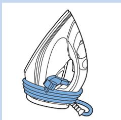
**3** Înfășurați cablul de alimentare în jurul tălpii suport a aparatului și fixați cablul cu o clemă. Depozitați fierul sprijinit în poziție verticală într-un loc sigur și uscat.
