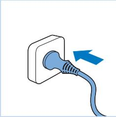
**1** Csatlakoztassa a hálózati dugót földelt fali konnektorba.
