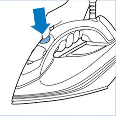
Tijekom glačanja možete koristiti način rada ECO radi uštede energije, pri čemu ipak imate dovoljno pare za glačanje svih odjevnih predmeta.
