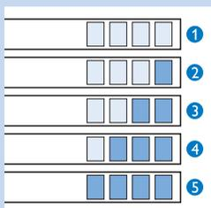
**3** Verificați câte pătrățele de pe banda de test și-au schimbat culoarea și comparați cu detaliile din tabelul pentru duritatea apei de mai jos.
