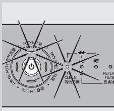
▶ 此时，控制面板上的电源指示灯、AUTO（自动）指示灯、AIR QUALITY（空气质量）指示灯将亮起。
