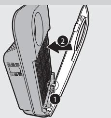
**8** 要装回前面板, 请首先将底部的挂钩插到产品底部 (1)。然后, 朝产品机身方向推动面板 (2)。
