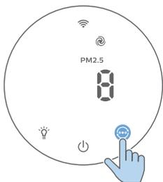
**Modalità Turbo (☯):** il purificatore d'aria funziona alla massima velocità.
