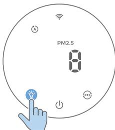
Con il sensore luminoso, il pannello di controllo può accendersi, spegnersi o attenuarsi automaticamente in base all'illuminazione ambientale. Il pannello di controllo si spegne o si attenua quando l'illuminazione ambientale è scura.
