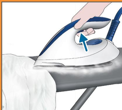
Halten Sie den Dampfauslöser zum Dampfbügeln gedrückt.
