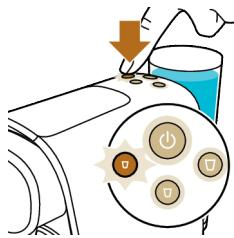
8 Die Ristretto-Taste beginnt schnell zu blinken. Drücken Sie die Ristretto-Taste, um den Entkalkungsvorgang zu aktivieren. Die Maschine gibt die gesamte Entkalkungslösung in regelmäßigen Abständen aus. Dies dauert bis zu 30 Minuten.
