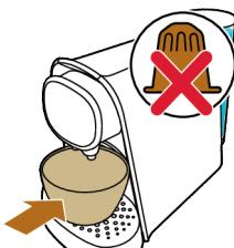
**3** Placez un bol sous le double bec-verseur. N'insérez pas de capsule et assurez-vous que le levier est fermé.
