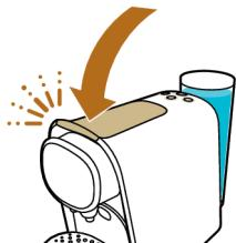
6 Plaats een kom met een inhoud van minstens 1,5 liter op de onderste lekbak, onder de koffie-uitloop, om de ontkalkingsoplossing op te vangen.
