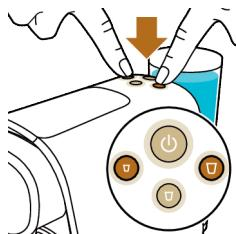
8 Ristretto-knappen begynder at blinke hurtigt. Tryk på ristretto-knappen for at aktivere afkalkningscyklussen. Maskinen dispenserer med jævne mellemrum hele afkalkningsopløsningen. Dette tager op til 30 minutter.
