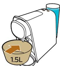
6 Stellen Sie eine Schüssel mit einem Fassungsvermögen von mindestens 1,5 Litern auf die untere Abtropfschale unter den Kaffeeauslauftrichter, um die Entkalkungslösung aufzufangen.
