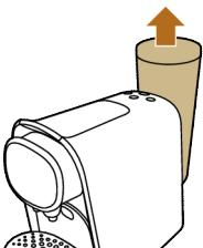
**1** Retirez le réservoir d'eau de la machine.
