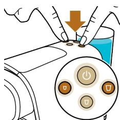
**8** Il pulsante Ristretto inizia a lampeggiare rapidamente. Premete il pulsante Ristretto per attivare il ciclo di rimozione del calcare. La macchina eroga l'intera soluzione anticalcare a intervalli regolari. Questo ciclo richiede circa 30 minuti.
