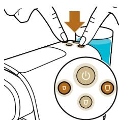
8 De ristrettoknop begint snel te knipperen. Druk op de ristrettoknop om de ontkalkingscyclus te activeren. De ontkalkingsoplossing stroomt met regelmatige tussenpozen uit het apparaat. Dit duurt maximaal 30 minuten.
