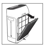
2 要卸下预过滤网,请向下按固定 夹, 然后朝您自己的方向拉动 过滤网。
