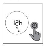
• 要停用定时器/重置功能,请反复轻触定时器按钮①,直至屏幕上显示"---"。
