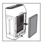
5 将预过滤网放回产品,请先将预过 滤网安装到产品的底部,然后将 固定夹放在产品方向的预过滤网的 顶部。
