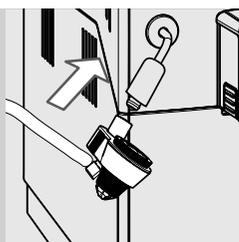
**27** Insérer le Mousseur à lait Automatique dans le protecteur en caoutchouc.
