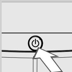
**9** Mettre l'interrupteur général qui se trouve au dos de la machine sur « I ». Pour mettre la machine en marche, appuyer sur la touche «
