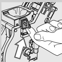
**13** S'assurer que le crochet pour le blocage du groupe de distribution est dans la bonne position. S'il est encore en position baissée, le pousser vers le haut jusqu'à l'accrocher correctement.
