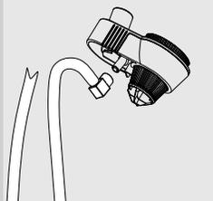
**3** Insérer le tuyau d'aspiration dans le Mousseur à lait Automatique.
