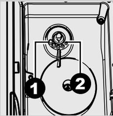
**3** Les repères à l'intérieur du réservoir à café en grains indiquent le degré de mouture réglé. 5 degrés de mouture différents peuvent être réglés, de la position 1 (●) pour une mouture grosse et un goût plus léger, à la position 2 (◐) pour une mouture fine et un goût plus fort. Si le café est aqueux ou s'il coule lentement, modifier les réglages du moulin à café.
