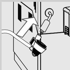
**4** Insérer le Mousseur à lait Automatique dans le logement de la buse de vapeur.
