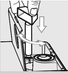
**2** Pendant que la machine est en train de moulin, appuyer et tourner d'un cran à la fois le bouton de réglage de la mouture qui se trouve à l'intérieur du réservoir à café en grains. Pour ce faire, utiliser la clé de réglage du moulin à café fournie avec la machine. La différence de goût sera perceptible après la distribution de 2 ou 3 cafés.
