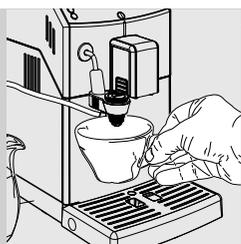
**7** Positionner une tasse sous le Mousseur à lait Automatique.
