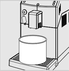
**12** Vider le récipient et le replacer sous la buse de vapeur/eau chaude et sous la buse de distribution du café.
