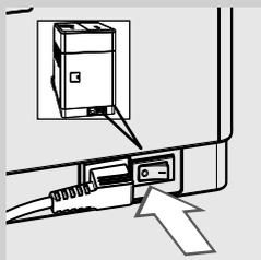
**7** Mettre l'interrupteur général qui se trouve au dos de la machine sur « 0 ».
