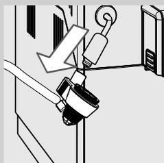
**15** Retirer le Mousseur à lait Automatique de la buse de vapeur.
