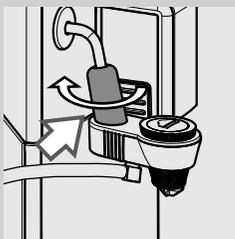
**5** Vérifier qu'il est bien positionné. S'il n'est pas possible de l'insérer, tourner la couverture chromée. Le Mousseur à lait Automatique est monté correctement quand le cran réussit à s'insérer dans la rainure.
