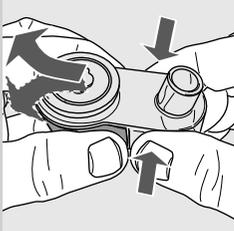
**19** Pour démonter le Mousseur à lait Automatique, appuyer sur les côtés et le retirer en effectuant de légers mouvements latéraux comme le montre la figure.
