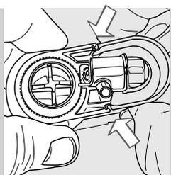
**23** Monter le Mousseur à lait Automatique dans le raccord en s'assurant qu'il est fixé correctement dans les logements indiqués.
