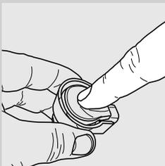
**22** Monter le couvercle en appuyant sur la partie centrale ; s'assurer qu'il est bien installé.
