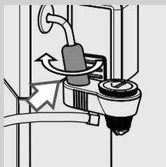
**28** Vérifier qu'il est bien positionné. S'il n'est pas possible de l'insérer, tourner la couverture chromée. Le Mousseur à lait Automatique est monté correctement quand le cran réussit à s'insérer dans la rainure.
