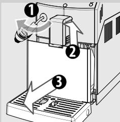
**16** Pour nettoyer le bac d'égouttement, mettre une tablette de dégraissage dans le bac et le remplir pour 2/3 avec de l'eau chaude. Laisser agir la solution de nettoyage pendant 30 minutes environ, puis rincer abondamment.
