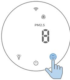
**Mode Turbo (☯):** Pemurni udara beroperasi pada kecepatan tertinggi.
