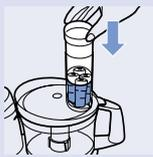
**8** Para quitar el accesorio de su soporte, cojan el soporte del accesorio con sus manos y con la parte trasera del inserto hacia Udes. Presionen los hilos del accesorio con sus pulgares para hacer que el inserto se separe del soporte.
