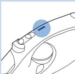
Благодаря функции автовыключения утюг отключается автоматически, если не используется более 30 секунд (в горизонтальном положении) или более 8 минут (в вертикальном положении). Загорается индикатор автовыключения.
