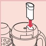
**8** Se for necessário, empurre os ingredientes para baixo com o pressor. Mantenha o pressor dentro do tubo para evitar salpicos.
