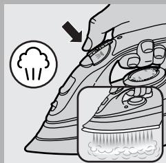
Silný impulz pary pomáha vyžehliť silne pokrčené oblečenie. Funkciu Impulz pary môžete použiť len pri nastavení teploty medzi ●● a MAX.
