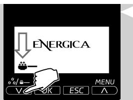
**2** Выберите функцию подачи предварительно намолотого кофе, нажав кнопку "OK". На дисплее машины отобразится символ, указанный сбоку.
