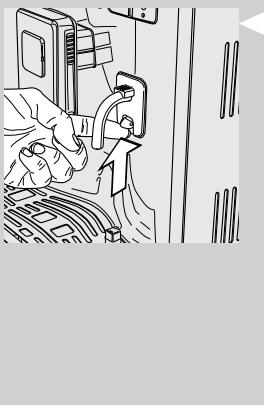
**1** Если установлено устройство подачи воды, снимите его, как показано на рисунке:
