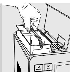
**5** Поднимите крышку и извлеките бак для воды, пользуясь ручкой.
