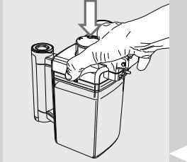
**4** Установите на место крышку и закройте устройство подачи графина, повернув его против часовой стрелки.
