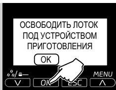
**10** Опорожните поддон для сбора капель (внутренний) и вставьте его на место, затем нажмите кнопку "OK".
