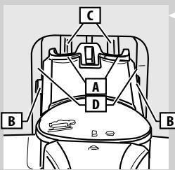
В этой фазе отверстия графина (A) находятся ниже соединений (C). Штыри (B) находятся на одной высоте с направляющими (D).
