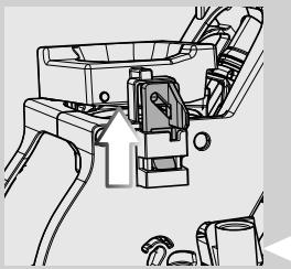
**9** Убедитесь, что фиксатор блока приготовления кофе находится в правильном положении, нажав кнопку «PUSH» до щелчка. Убедитесь в том, что фиксатор поднялся вверх до упора. В противном случае попробуйте еще раз.
