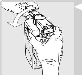
**7** Установите устройство подачи молока в положение блокировки, повернув его против часовой стрелки.
