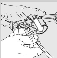
**7** Снимите всасывающую трубку.
