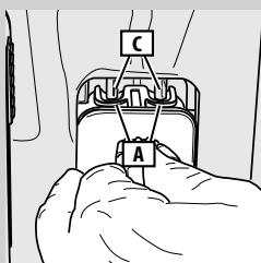
В этой фазе отверстия устройства подачи (A) находятся ниже соединений (C). Штыри устройства подачи находятся на одной высоте с направляющими.
