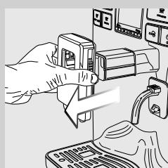
**6** Извлеките устройство подачи и вымойте его водой.
