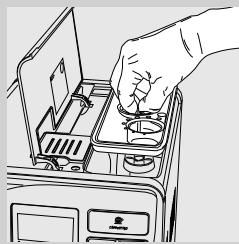
**8** Поднимите крышку емкости для кофе в зернах и извлеките внутреннюю крышку.
