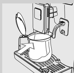
**6** Установите емкость (1,5 л) под устройство подачи кофе. Нажмите кнопку "OK" для включения цикла очистки.
