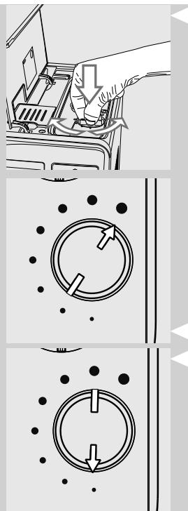
**2** Нажмите и поверните ручку ручка регулировки помола только на одно деление за раз. Разница вкуса будет ощутимой после подачи 2-3 эспрессо.
