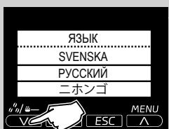
**13** На экране появится следующее изображение. Выберите желаемый язык нажатием кнопок прокрутки " $\backslash$ " или " $/$ ".
