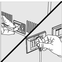
**10** Вставьте штепсельную вилку в розетку, расположенную в задней части машины.
