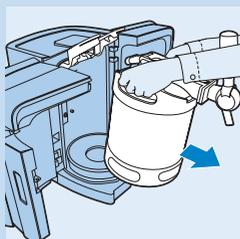
**3** Incline el barril hacia usted con la unidad del grifo montada y sáquelo del aparato.
