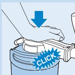
**5** Coloque la unidad del grifo en la pieza superior de conexión del barril empujándolo hacia abajo firmemente ("clíc").
