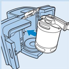
**3** Incline ligeramente hacia delante el barril con la unidad del grifo colocada y póngalo en el aparato.
