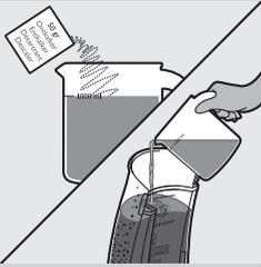
**2** Mélangez 50 grammes d'acide citrique avec 1 litre d'eau. Remplissez le réservoir d'eau avec la solution de détartrage. Remuez jusqu'à dissolution complète de la poudre.
