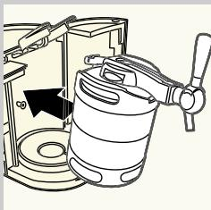
**3** Stellen Sie das Fass mit der montierten Zapfeinheit in das Gerät. Kippen Sie dabei das Fass leicht nach vorn.
