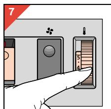
Το θερμαντικό σώμα θα διατηρεί το χώρο γύρω ζεστό στη θερμοκρασία που το ρυθμίσατε, ενώ θα ανάβει και θα σβήνει μόνο του κατά διαστήματα καθώς θα χαμηλώνει η θερμοκρασία. Μπορείτε να ρυθμίζετε τη θερμοκρασία κατά τη λειτουργία του.
