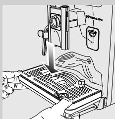
**4** Introduceți în aparat cuva de colectare a picăturilor (externă), prevăzută cu tăvita. Verificați dacă este introdusă corect.
