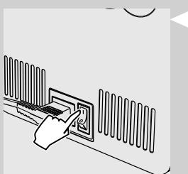
**12** Comutați întrerupătorul general în poziția „I” pentru a porni aparatul.
