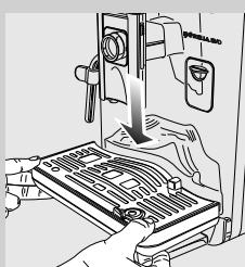
**5** Uscați grila, montați-o și reașezați-o în aparat.
