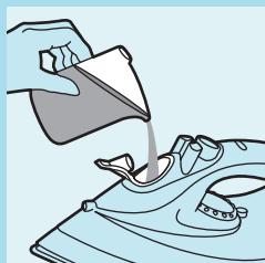
**5** 使用量杯将水箱注满至最高水位。
