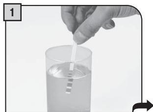
Sumergir en agua durante 1 segundo la tira de test que se suministra con la máquina para la prueba de la dureza del agua.
