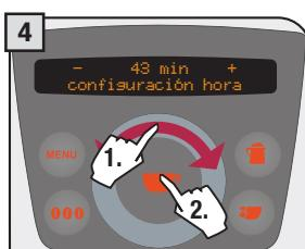
Ajustar los minutos deslizando el dedo sobre el disco táctil.
