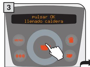
Pulsar para realizar la carga del circuito; esperar a que la máquina termine esta fase.
