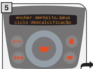
Retire o depósito de água, enxágüe-o com água fresca potável para eliminar resíduos de solução descalcificante, depois encha-o com água fresca potável.
