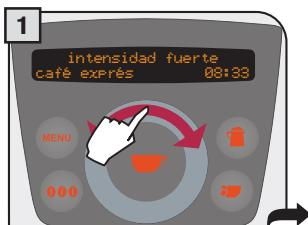
Deslizar un dedo sobre el disco táctil para seleccionar el producto deseado.
