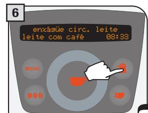
A máquina propõe a limpeza dos circuitos do leite. Pressione a tecla para realizar a limpeza dos circuitos internos.
