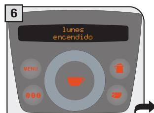
Ajustar la hora de encendido deslizando el dedo sobre el disco táctil.
