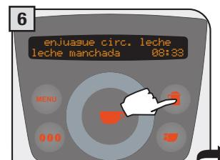
La máquina propone la limpieza de los circuitos de leche. Pulsar la tecla para iniciar la limpieza de los circuitos internos.
