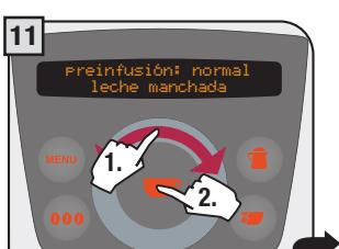
Deslizar el dedo sobre el disco táctil para cambiar el valor de la preinfusión (normal, fuerte, desactivada). Pulsar ☕ para memorizar. Salir pulsando la tecla  **MENU**.
