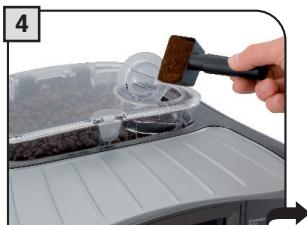
Deite café moído no compartimento apropriado utilizando o medidor fornecido em dotação.
