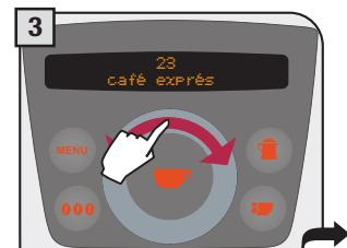
Deslizar el dedo sobre el disco táctil para visualizar los datos relativos a cada tipo de bebida.
