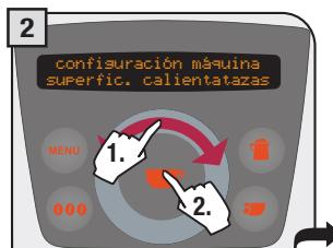
**3** Seleccionar deslizando el dedo sobre el disco táctil.
