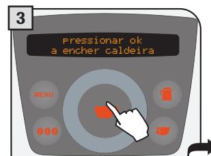
Pressione para realizar o carregamento do circuito; aguarde que a máquina termine esta fase.
