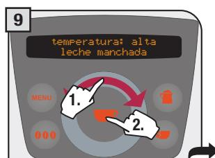
Deslizar el dedo sobre el disco táctil para cambiar el valor de la temperatura (alta, media, baja). Pulsar ☕ para memorizar.
