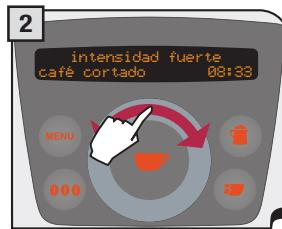
Seleccionar el cortado deslizando el dedo sobre el disco táctil.
