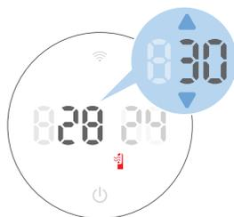
En la función **Calefacción**, pulse el botón △/▽ para ajustar la temperatura, que oscila entre 1 °C y 37 °C.
