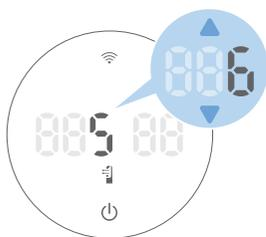
En la función **Ventilador/Circulación**, pulse el botón △/▽ para ajustar la velocidad del ventilador, que va de 1 a 10.
