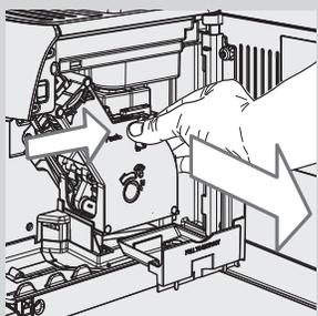
**3** Insérer une tablette de dégraissage dans le compartiment du café prémoulu.
