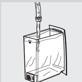
**12** Extraire le réservoir à eau, le rincer et le remplir avec de l'eau fraîche jusqu'au niveau MAX. Le réinsérer dans la machine.
