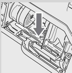
**1** Appliquer la graisse uniformément sur les deux convoyeurs latéraux.
