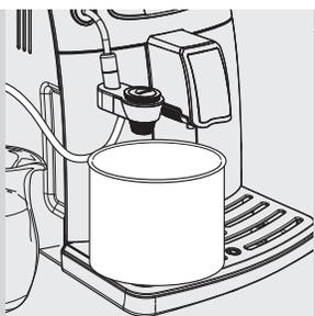
**11** Vider le récipient et le replacer sous le Mousseur à lait Automatique.
