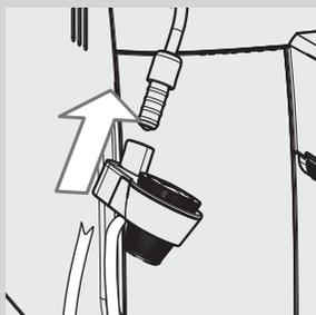
**3** Introduire le Mousseur à lait Automatique dans le logement de la buse vapeur jusqu'à l'enclenchement.
