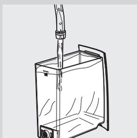
10 À la fin de cette opération, remplir à nouveau le réservoir à eau jusqu'au niveau MAX. La machine est enfin prête à distribuer du café. Le message indiqué à gauche s'affichera.
