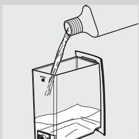
6 Extraire le réservoir à eau et y verser tout le contenu du détartrant Saeco. Remplir le réservoir avec de l'eau fraîche jusqu'au niveau MAX.
