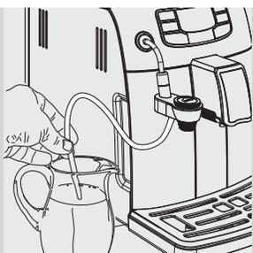
4 Mettre le tuyau d'aspiration dans le réservoir à lait.
