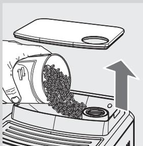
**8** Prendre le couvercle du réservoir à café en grains et verser lentement le café en grains dans le réservoir.
