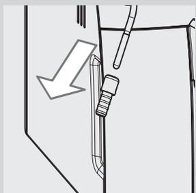
**18** Enlever le raccord en caoutchouc de la buse de vapeur.
