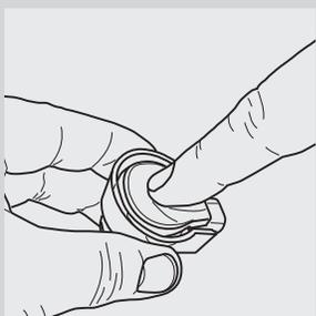
**23** Monter le couvercle en appuyant sur la partie centrale ; s'assurer qu'il est bien installé.
