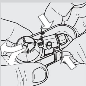
**20** Pour démonter le Mousseur à lait Automatique appuyer sur les côtés et le retirer en effectuant de légers mouvements latéraux comme le montre la figure.
