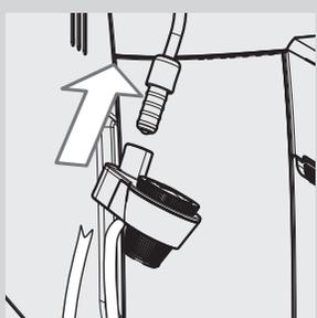
**7** Introduire le Mousseur à lait Automatique dans le logement de la buse vapeur jusqu'à l'enclenchement.
