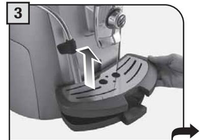
3 Die Abtropfschale herausnehmen, entleeren und reinigen.
