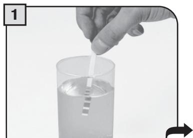
Immergere, per 1 secondo nell'acqua, il provino per i test di durezza dell'acqua, presente nella macchina.
