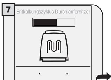
Die Maschine beginnt mit der Ausgabe der Entkalkungslösung über die Ausgäbe des heißen Wassers. Die Ausgabe erfolgt in voreingestellten Intervallen, um die optimale Wirkung der Lösung zu gewährleisten.
