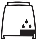
Die seitliche Tür öffnen und die Abtropfschale, die sich unter der Brühgruppe befindet, leeren.
