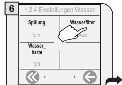
6 Die Programmierung öffnen (siehe S. 21 und 23). „Einstellungen Wasser“ drücken. Wasserfilter anwählen.
