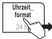
Einstellung des Anzeigeformats der Uhrzeit. Die Maschine ermöglicht die Anzeige der Uhrzeit auch im angelsächsischen Format (am/pm).
