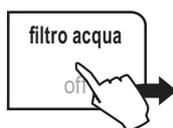
Per attivare/disattivare l'avviso di sostituzione del filtro acqua. Attivando questa funzione la macchina avvisa l'utente quando il filtro acqua deve essere sostituito.
