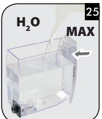
UA Вийміть водяний бакоч. Наповніть його свіжою водою до рівня MAX. Знову встановіть його в машину.
