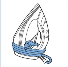
**3** Wickeln Sie das Kabel hinten um das Gerät, und befestigen Sie es mit dem Kabelclip. Bewahren Sie das Bügeleisen in senkrechter Position an einem sicheren und trockenen Ort auf.
