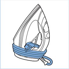
3 Enroulez le cordon d'alimentation autour du talon de l'appareil et fixez-le à l'aide de la bride. Rangez le fer sur son talon dans un endroit sûr et sec.
