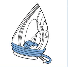
**3** Wikkel het netsnoer rond de achterkant van het apparaat en zet het snoer vast met de snoerclip. Berg het strijkijzer op zijn achterkant op een veilige en droge plaats op.
