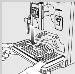
**4** Insérer dans la machine le bac d'égouttement (externe) avec sa grille. Vérifier qu'il est correctement inséré.
