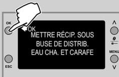
**12** Vider le récipient et le replacer sous la buse de distribution vapeur/eau chaude et sous la buse de distribution du lait de la carafe. Appuyer sur la touche « **OK** ».
