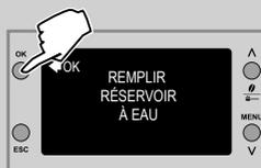
**4** Remplir le réservoir avec de l'eau fraîche jusqu'au niveau MAX. Appuyer sur la touche « **OK** ».
