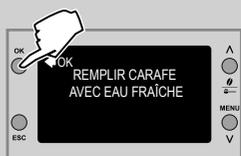
**14** Laver soigneusement la carafe à lait et la remplir d'eau fraîche. Insérer la carafe à lait dans la machine. Appuyer sur la touche « **OK** » pour confirmer.
