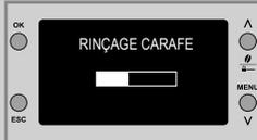
**16** La machine commence à distribuer de l'eau depuis la buse de distribution du café et depuis la buse de distribution du lait. La barre permet de vérifier l'état d'avancement du cycle.
