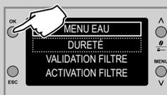
**7** Sélectionner l'option DURETÉ en appuyant sur la touche « **OK** » et programmer la valeur de la dureté de l'eau.
