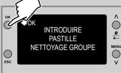
5 Insérer une tablette de dégraissage dans le compartiment du café prémoulu. Appuyer sur la touche « **OK** ».
