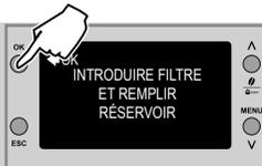
**12** Appuyer sur la touche « **OK** » pour confirmer l'introduction du filtre à eau et le remplissage du réservoir.
