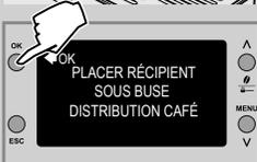
6 Placer un récipient (1,5 l) sous la buse de distribution du café. Appuyer sur la touche « **OK** » pour démarrer le cycle de nettoyage.
