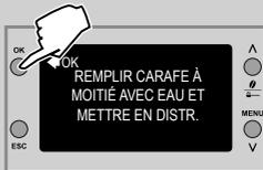
**11** Vider la carafe à lait et la remplir d'eau fraîche. La réinsérer dans la machine. Appuyer sur la touche « **OK** ».
