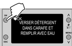
**10** Appuyer sur la touche « **OK** » pour démarrer le cycle. La machine commence la distribution de la solution à travers la buse de distribution du lait.
