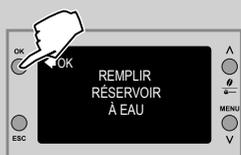
**12** À la fin de la distribution, remplir le réservoir avec de l'eau fraîche jusqu'au niveau MAX. Appuyer sur la touche « **OK** » pour confirmer.
