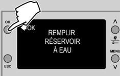
4 Remplir le réservoir à eau avec de l'eau fraîche jusqu'au niveau MAX. Appuyer sur la touche « **OK** ».
