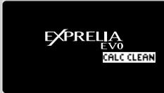
Le calcaire qui se forme à l'intérieur de la machine au cours de l'utilisation doit être éliminé régulièrement ; dans le cas contraire, le circuit hydraulique et du café peuvent se boucher. La machine signalera quand il sera nécessaire de procéder au détartrage.
