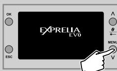
**4** Il est à présent possible de programmer les réglages de dureté de l'eau. Appuyer sur la touche « **MENU** » pour accéder au menu principal de la machine.
