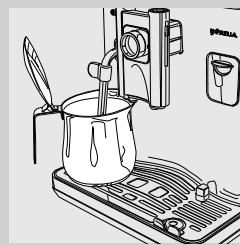
**1** Установите емкость под трубку пара/горячей воды.
