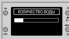
Регулируя полоску на дисплее с помощью кнопок прокрутки "V" или "A", можно выбрать количество подаваемой горячей воды.
