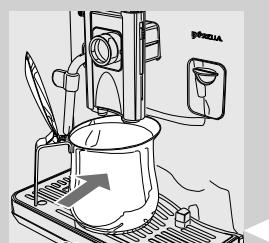
6 Установите емкость (1,5 л) под устройство подачи кофе. Нажмите кнопку "**OK**" для запуска цикла очистки.
