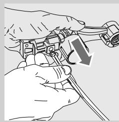
**7** Снимите всасывающую трубку.
