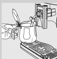
**1** Установите емкость с напитком, который вы желаете разогреть, под трубку пара / горячей воды.
