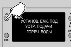
**13** Нажмите кнопку "OK", чтобы подтвердить наличие емкости под устройством подачи воды.
