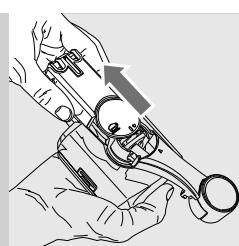
**5** Извлеките соединитель, соединяемый с машиной.
