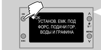
**12** Опорожните емкость и снова установите ее под устройство подачи горячей воды / пара и устройство подачи молока графина. Нажмите кнопку "OK".
