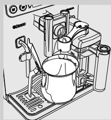
**15** Опорожните емкость и снова установите ее под устройство подачи кофе. Откройте устройство подачи молока, повернув его по часовой стрелке.
