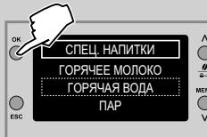
**3** Выбрав нажатием кнопок прокрутки "V" или "A" ГОРЯЧАЯ ВОДА, подтвердите посредством кнопки "OK".
