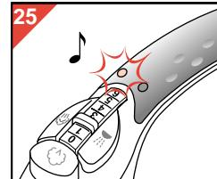
Om aan te geven dat het strijkijzer zichzelf heeft uitgeschakeld, gaat het rode "Auto Stop" controlelampje (O) knipperen en hoort u een geluidssignaal (fig. 25).
