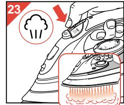
Der Dampfstoß kann nur bei Temperaturen im Dampfbereich, also ●● oder ●●●, angewendet werden.
