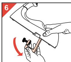
L'étrier peut rester replié. Les pieds anti-dérapants du socle assurent la stabilité de l'ensemble. Toutefois, à cause des risques de chutes il est préférable de ne pas l'utiliser ainsi sur une
