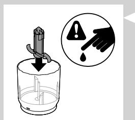
**1** Rezilno enoto namestite v posodo za sekljanje.
