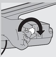
**9** Înșurubați strâns la loc capacul de clătire pentru detartrare la generatorul de abur.
