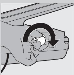
**9** Щільно закрійте генератор пари промивною кришкою Calc-Clean.
