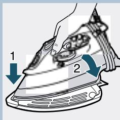
**4 Захисне покриття для зберігання (стосується лише приладу типу GC 4043 / 4028).**
