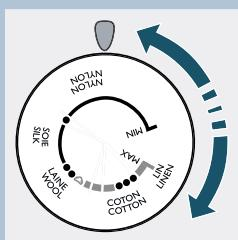
**3 Reglați termostatul la temperatura necesară pentru călcare răsucindu-l pe poziția indicatorului de temperatură.**
