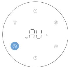
**自动模式：**加湿器会根据环境空气湿度自动调节风速。屏幕上显示AU，3秒后，恢复正常显示。
