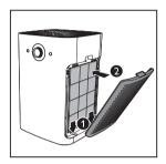
**7** 重复上述步骤,组装产品另一侧的空气净化滤网。
