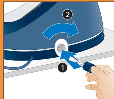
Wenn kein Wasser mehr austritt, setzen Sie den EASY-DE-CALC-Verschluss wieder auf, und drehen Sie ihn im Uhrzeigersinn fest.
