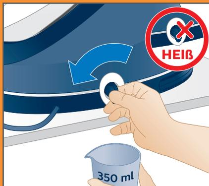
Stellen Sie die Dampfbügelstation an die Kante eines Tisches oder Waschbeckens, und halten Sie eine Tasse unter den EASY DE-CALC-Verschluss.
