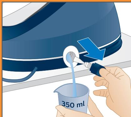
Entfernen Sie den EASY DE-CALC-Verschluss, und lassen Sie das Wasser mit Kalkpartikeln in die Tasse fließen.
