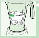
■ 把溫水和一些清洗液倒入混和廣口瓶中。 不要超過混和瓶的最大量(1.5 升)。
