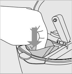
**3** Setzen Sie eine Papierfiltertüte (Größe 101) in den Filterhalter.
