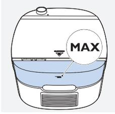
تم تزويد جهاز طهو الطعام بواسطة الهواء بخزان مياه موجود في الجهة الخلفية من الجهاز. يبلغ مستوى المياه MAX (الحد الأقصى) 600 مل تقريبًا. يتوفر مؤشر مستوى المياه MAX (الحد الأقصى) على جانب مقبض خزان المياه ويجب عدم تجاوزه. لتجنب تراكم الكلس، أفرغ خزان المياه بعد كل دورة طهو.
