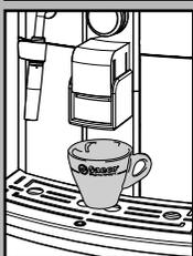
Para realizar o ajuste, levante ou baixe manualmente o grupo de distribuição colocando os dedos conforme apresentado na figura.
