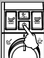
**i** Obs.: durante a fase de desligamento a máquina realiza um ciclo de enxágue, quando tiver sido distribuído um produto de café. **Atenção:** durante a ligação da máquina após um desligamento completo, a máquina apresentar-se-á na posição de Stand-by.
