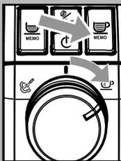
**i** Obs.: se imediatamente após o início, a tecla “MEMO” se acender de modo fixo, a máquina necessita do carregamento do circuito; rode o selector no sentido dos ponteiros do relógio até ao ponto “MEMO”. Quando aparecer o símbolo “⚠” volte a colocar o selector na posição “MEMO”.
