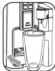
**!** Po přípravě napěněného mléka se rozsvítí tlačítko proplachování
