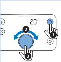
↳ O temporizador da função de manter quente está definido para 30 minutos. Para alterar o tempo de manter quente (1-30 min.), prima o botão do temporizador (⌚), rode o seletor QuickControl e, em seguida, prima-o para confirmar. Não é possível ajustar o tempo da função de manter quente.
