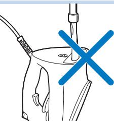
Nu turnă apă, oțet, agenți de detartrare sau alte substanțe chimice în fier prin orificiul pentru funcția de detartrare rapidă.
