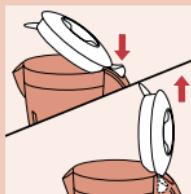
**4** 要打开缸盖时，压一下手柄侧面的弹射器。
