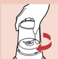
**4** 将安装好的研磨器上下翻转，并按箭头所示的方向将其固定在电动机单元上。
