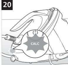
**Il est très important d'utiliser la fonction EASY DE-CALC dès que le voyant EASY DE-CALC commence à clignoter (Fig. 20) et que l'appareil émet un signal sonore continu.**
