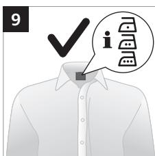
A tecnologia ActiveSense permite-lhe engomar todos os tipos de tecidos engomáveis, sem precisar de ajustar a regulação de temperatura do ferro. A luz de "ferro pronto" pode ficar acesa continuamente a azul ou a branco, correspondendo ao nível de temperatura/vapor necessário (normal e alto para a luz respetiva), com base no tecido detetado.
