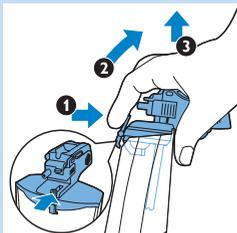
**3** Pressione a alavanca de liberação da tampa do recipiente para leite (1), incline-a um pouco (2) e erga-a para removê-la do recipiente para leite (3).
