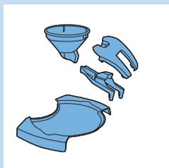
**5** Limpe a tampa do bocal, o bocal, o coletor de café e a bandeja de pingos em água quente (se necessário, com um pouco de detergente) ou coloque na lava-louças.
