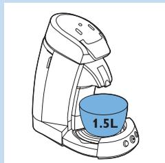
**4** Coloque um recipiente (com capacidade de 1,5 L) sob o bocal de saída do café para coletar a água.
