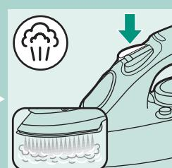
اگر آب منطقه شما بسیار سخت است توصیه میکنیم که آنرا با مقداری آب مقطر مخلوط کنید و یا فقط آب مقطر استفاده کنید.
