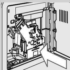
**12** Ополоснув блок приготовления кофе, вставьте его обратно в гнездо так, чтобы он защелкнулся в нужном положении (см. главу «Еженедельная чистка блока приготовления кофе»). Вставьте контейнер для сбора отходов и контейнер для сбора жидких отходов. Закройте дверцу для обслуживания.
