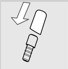
**26** Вставьте резиновую накладку в хромированный кожух (только для автоматического вспенивателя молока с хромированным кожухом).
