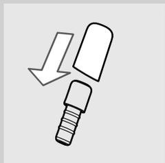
**18** Снимите хромированный кожух с резиновой накладкой. Снимите резиновую накладку с кожуха.
