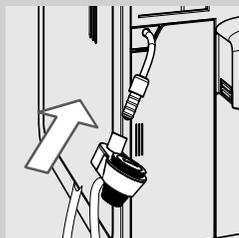
**28** Вставьте автоматический вспениватель молока в резиновую накладку до полной установки.
