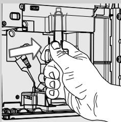
**5** Тщательно очистите канал выхода кофе с помощью специально прибора для чистки, поставляемого в комплекте с машиной, или с помощью рукоятки чайной ложечки. Убедитесь, что специальный прибор для чистки вставлен как показано на рисунке.
