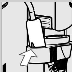
**28** Вставьте автоматический вспениватель молока. Убедитесь, что он расположен правильно. Если не получается вставить, нужно повернуть хромированный кожух. Автоматический вспениватель молока установлен правильно, когда шип вставлен в паз.
