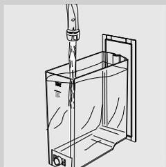
**11** По окончании еще раз наполните бак для воды до уровня MAX. С этого момента машина может использоваться для подачи кофе. На дисплее отобразится символ, указанный сбоку.
