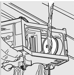
**11** Тщательно промойте блок приготовления кофе свежей водой.
