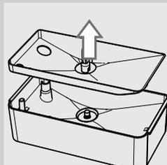
**5** Снимите лоток. Протрите лоток и емкость влажной тряпкой.
